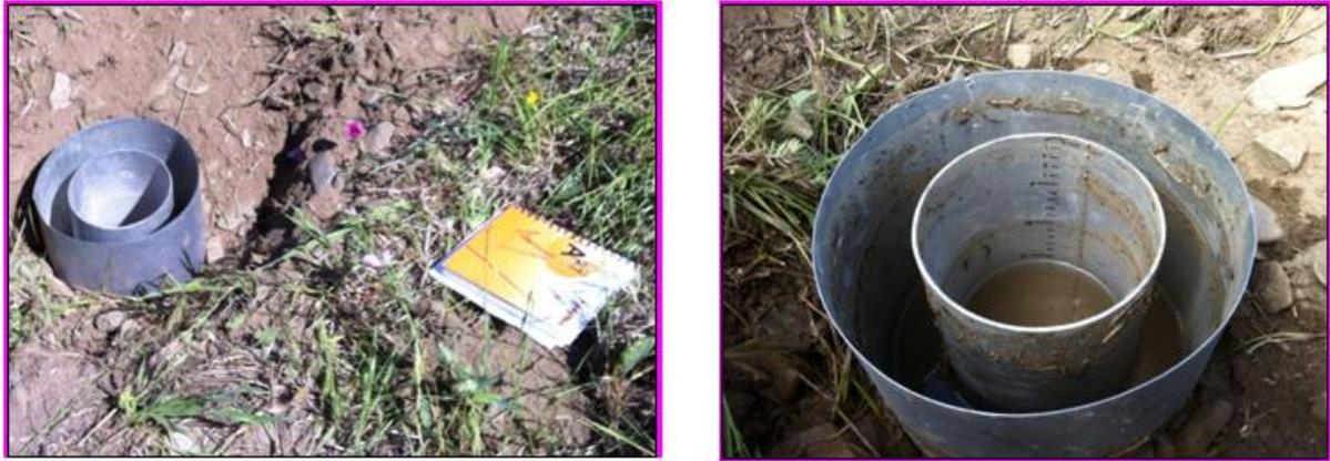
**Figura 3-7 Tests de infiltración.**
